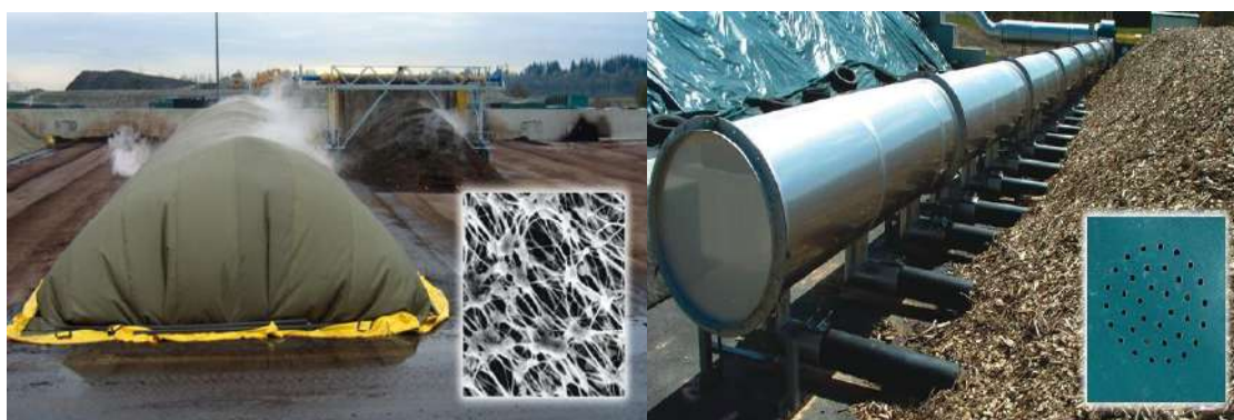
ภาพที่ 17 เทคโนโลยีการผลิตปุ๋ยหมักแบบควบคุมสภาวะ และลดการปลดปล่อยสารอินทรีย์ระเหยง่ายด้วยผ้าใบกันน้ำโพลีเอทิลีนในประเทศสหรัฐอเมริกา
