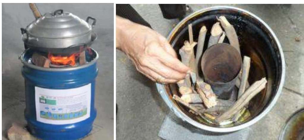
ภาพที่ 20 แบบเตาเผาไบโอชาร์แบบตั้ง ขนาดบรรจุ 50 ลิตร
